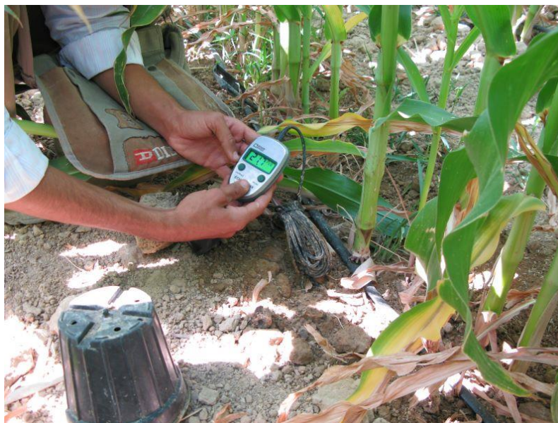
شکل ۱- اندازه‌گیری رطوبت خاک مزرعه ذرت با دستگاه رطوبت‌سنج خاک
