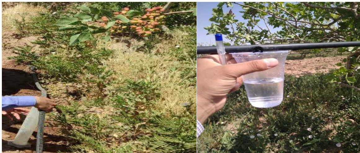
شکل ۱- اندازه‌گیری دبی قطره‌چکان‌ها در دو مزرعه A و B
