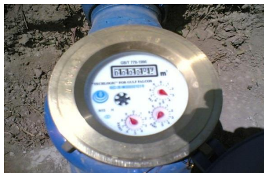
شکل ۲- اندازه گیری دبی آب آبیاری به کمک کنتور حجمی (راست) و فلوم WSC (چپ) به ترتیب در سامانه های آبیاری قطره ای نواری (تیپ) و سطحی
