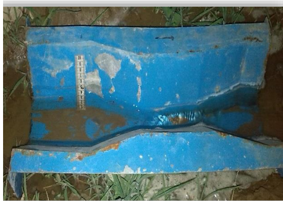
شکل ۵- استفاده از فلوم WSC در بخش خروجی جویچه
