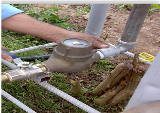
شکل ۴- کتور اندازه گیری آب مصرفی در آبیاری جویچه ای
