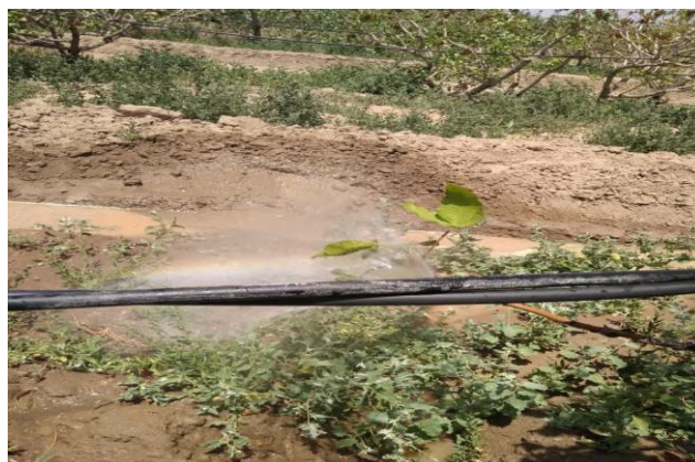
شکل ۱۰- کاهش راندمان آبیاری در اثر گسیختگی لوله‌های لترال
