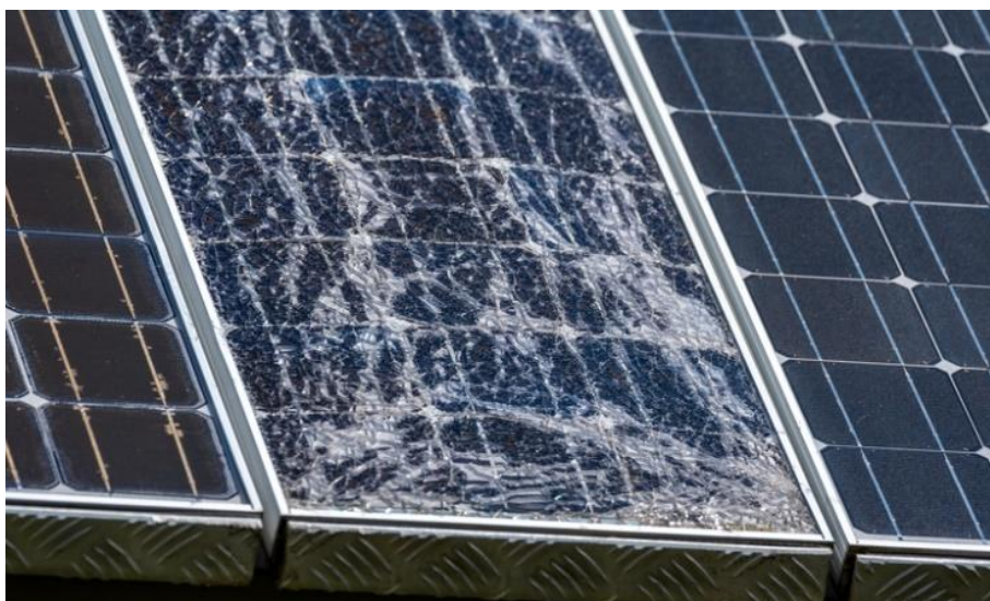
شکل ۶- نمونه‌ای از خسارت پاشش آب به پنل سامانه فتوولتائیک
