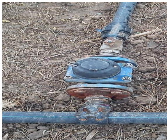
شکل ۱: اندازه‌گیری دبی آب آبیاری به کمک کنتور حجمی (راست) و فلوم WSC (چپ) به ترتیب در سامانه‌های آبیاری قطره‌ای و سطحی
