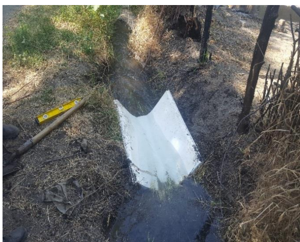
شکل ۱: اندازه‌گیری دبی آب آبیاری به کمک کنتور حجمی (راست) و فلوم WSC (چپ) به ترتیب در سامانه‌های آبیاری قطره‌ای و سطحی
