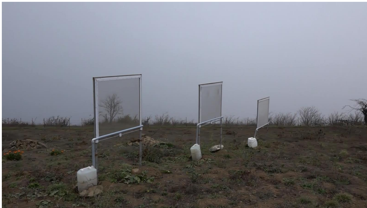
شکل ۷- نمایی از استقرار سامانه‌های جمع‌کننده آب از مه در روستای کوهستانی سراورسو اشکورات رودسر
