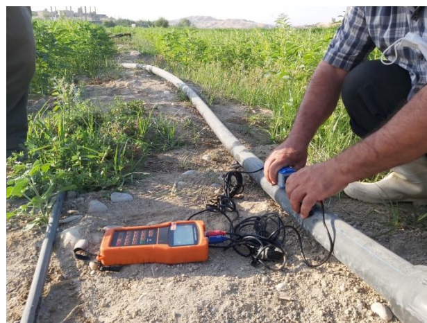
شکل ۲- اندازه‌گیری دبی آب آبیاری به روش اولتراسونیک (راست) و فلوم WSC تیپ ۵ (چپ) به ترتیب در دو سامانه آبیاری قطره‌ای و سطحی (جویچه‌ای)
