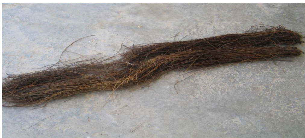
شکل ۳- توده جلبکی مسبب گرفتگی مجاری سامانه های آبیاری
