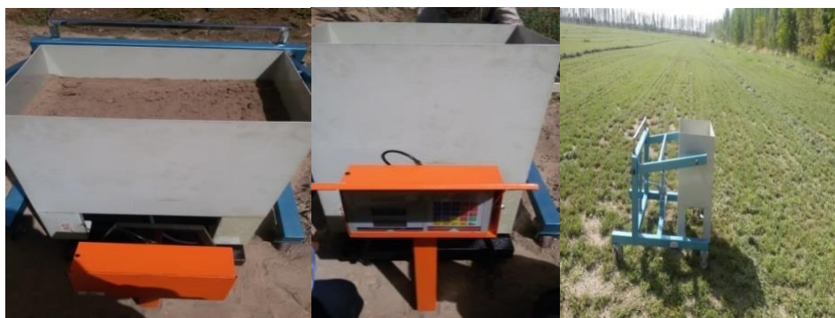
شکل ۲- میکرو لایسیمتر کار گذاشته شده در مزرعه
