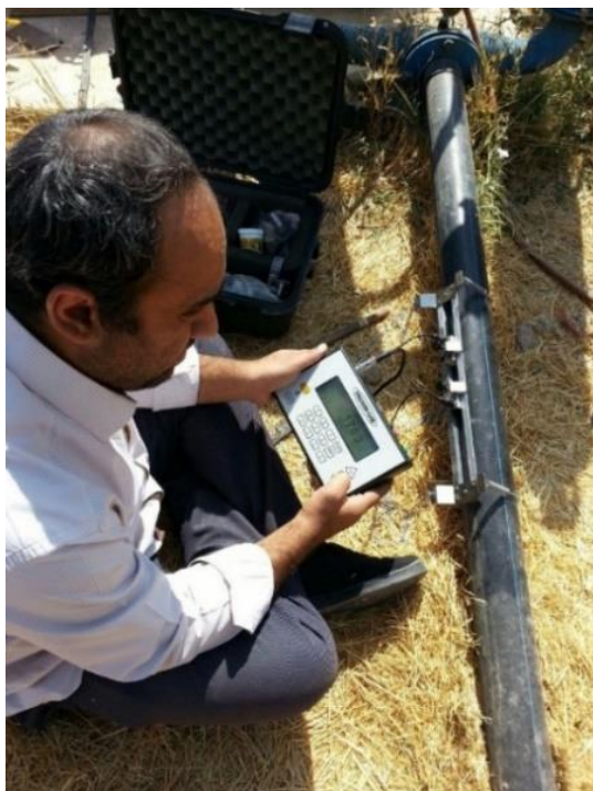
(ب) اندازه‌گیری میدانی دبی ورودی با استفاده از دبی سنج اولتراسونیک
