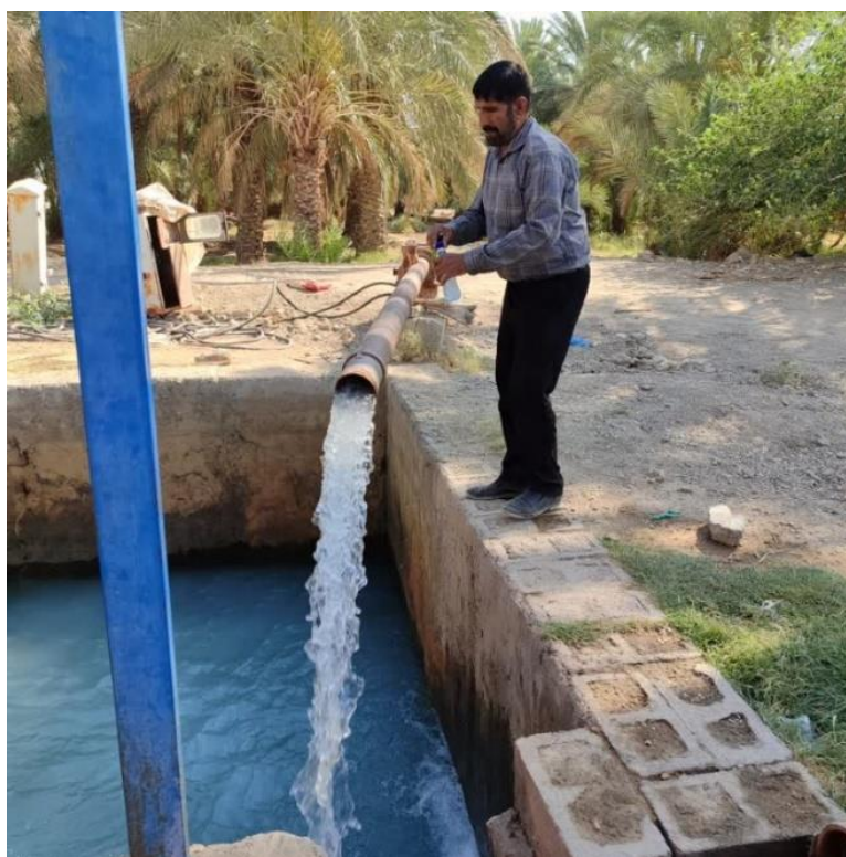
شکل ۲- نمونه برداری از چاه های آب
