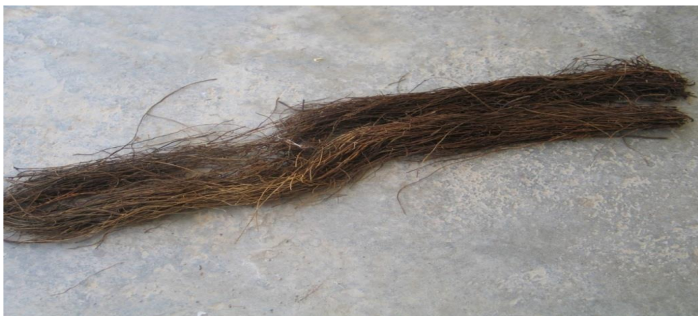
شکل ۳- توده جلبکی مسبب گرفتگی مجاری سامانه‌های آبیاری
