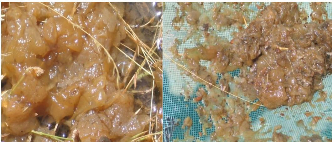
شکل ۲- تجمع بقایای باکتری اکسیدکننده آهن در مجاری سامانه آبیاری در منطقه رودان
