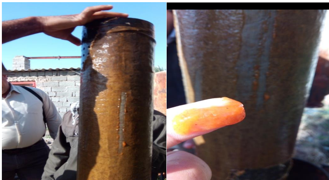
شکل ۴- رسوب بقایای باکتری‌ها بر روی فیلتر سامانه آبیاری
